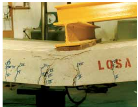
Fotografía 3.- Detalle de rotura plástica. Acero de alta ductilidad.
