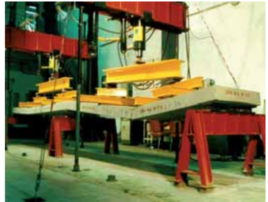
Fotografía 2.- Rotura dúctil de losa armada con acero de alta ductilidad.
