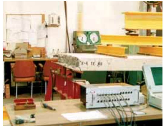
Fotografía 1.- Rotura frágil de losa armada con acero de baja ductilidad.
