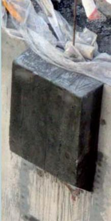
Una vez endurecido el hormigón se procede a la retirada de los encofrados y para mantener la trazabilidad alguien grava en su superficie su nombre.
