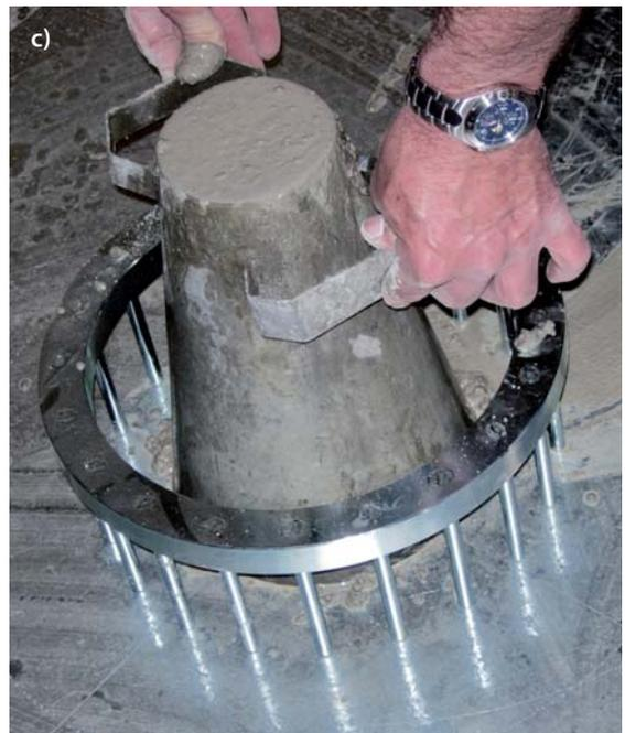
➡ Nuevos métodos de ensayo para hormigones autocompactantes: a) caja en L, b) embudo en V y c) anillo japonés.
