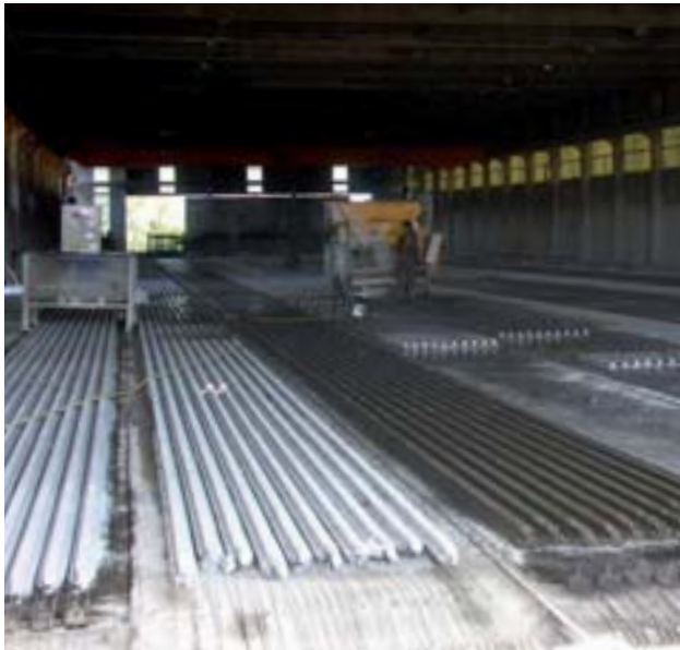
Figura 5.- Fabricación de las viguetas, en la que se pueden apreciar una línea completa de fabricación. Foto: PRENOR.
