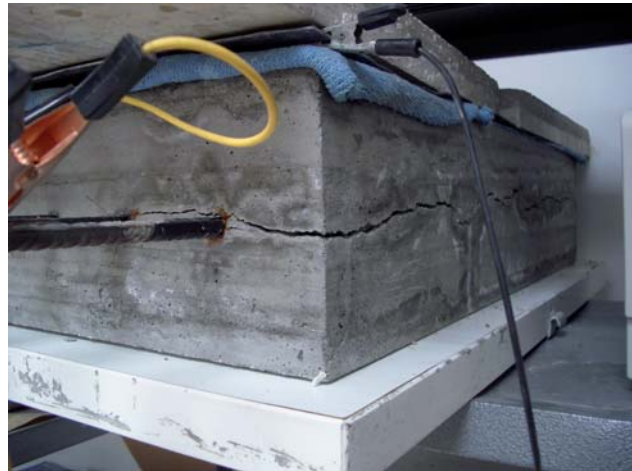
Figura 7.- Al avanzar el ensayo el aumento de volumen de los productos de corrosión produce la rotura de la placa de ensayo.
