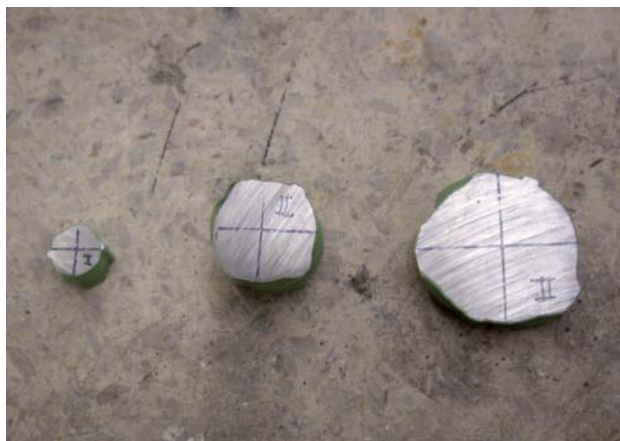
Figura 4.- Secciones transversales de las barras para la medida del espesor del recubrimiento.
