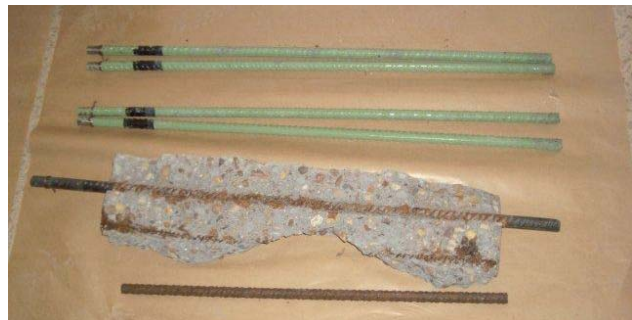
Figura 8.- Estado de las barras una vez finalizado el ensayo de corrosión.
