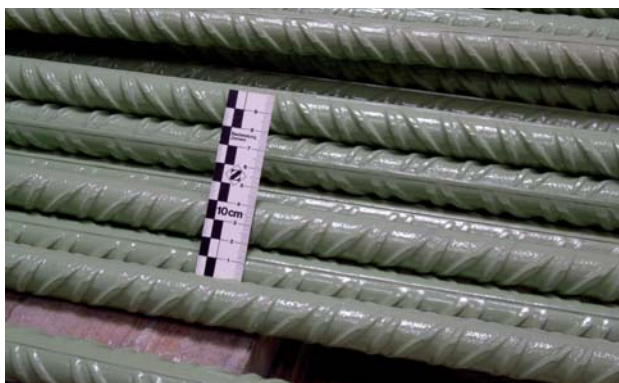
Figura 2.- Barras de acero B 500 SD revestido utilizadas en el estudio.
