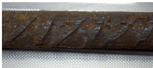
Figura 9.- Detalle del estado de las barras revestidas con defectos reparados tras el ensayo acelerado de corrosión y su comparación con la barra desnuda de referencia.
