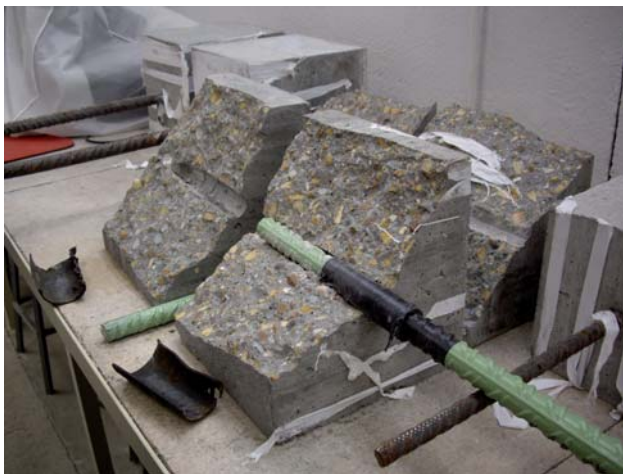
Figura 10.- Rotura de la probeta de ensayo de barras de 25 mm de diámetro.
