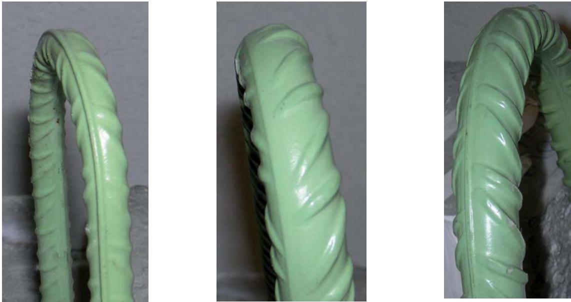
Figura 5.- Ausencia de defectos en las barras revestidas tras el doblado a 180°.
