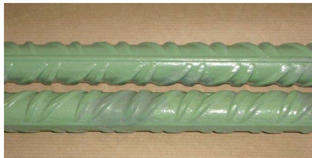
Figura 8.- Estado de las barras una vez finalizado el ensayo de corrosión.
