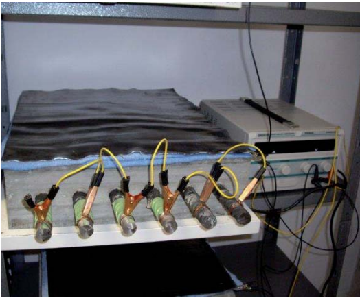
Figura 6.- Detalle del ensayo acelerado de corrosión.
